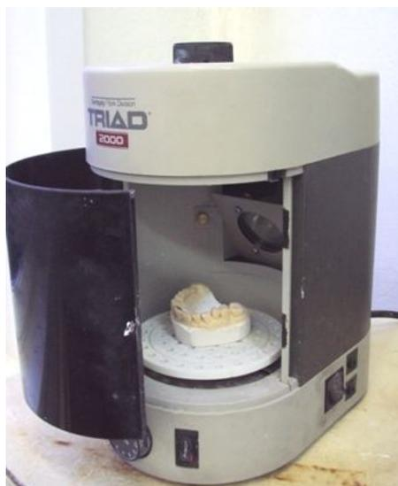
**Рис. 8. Лабораторный полимеризатор TRIAD 2000 (Dentsply).**
