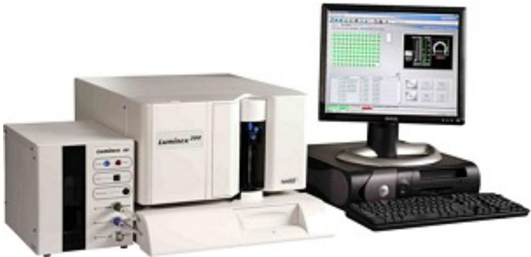
Рисунок 4. Анализатор Luminex 200
