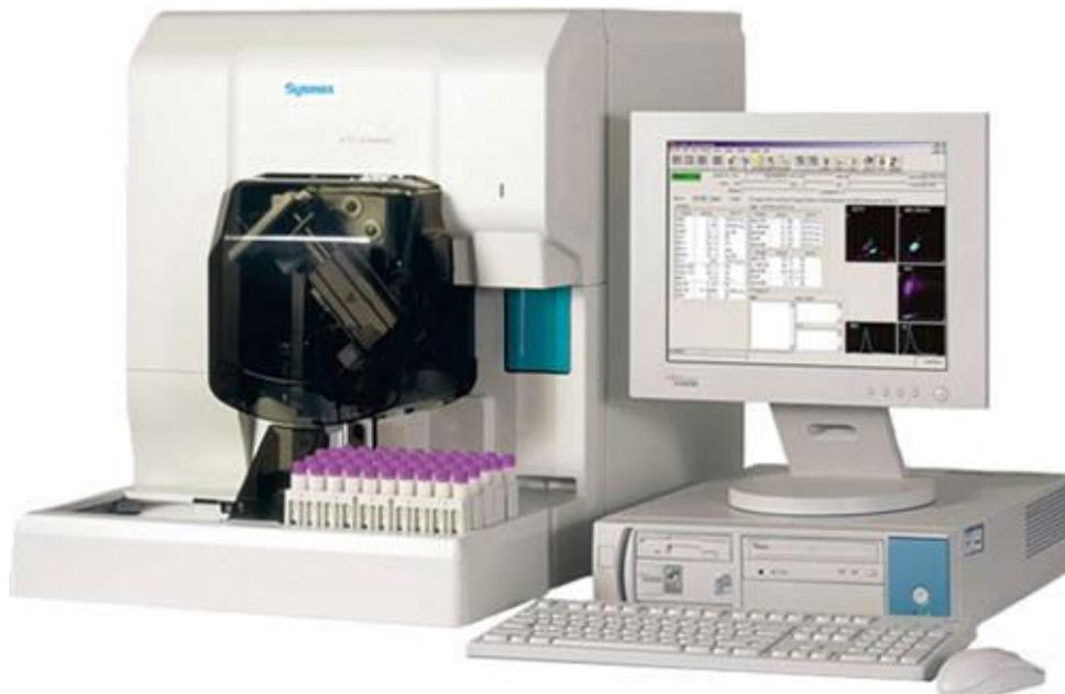
Рисунок 3. Автоматический гематологический анализатор
