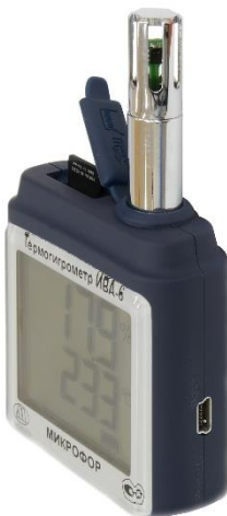
Рис.14. Термогигрометр Ива-6Н-КП с картой памяти.
