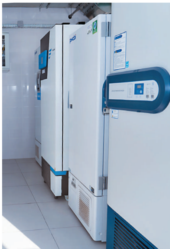
Криохранилище биобанка позволяет хранить образцы крови и клеток пациентов при температуре до -152^{\circ}\text{C}
