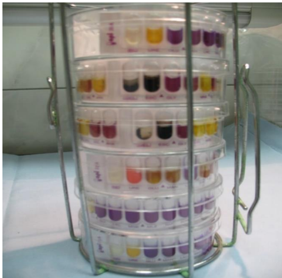
Рисунок 10 – Анаэроустат для приточно-вытяжной вакуумной системы (HiMedia Labs Ltd, Индия) для выделения и идентификации штаммов облигатно-анаэробных бактерий пародонтопатогенной группы
