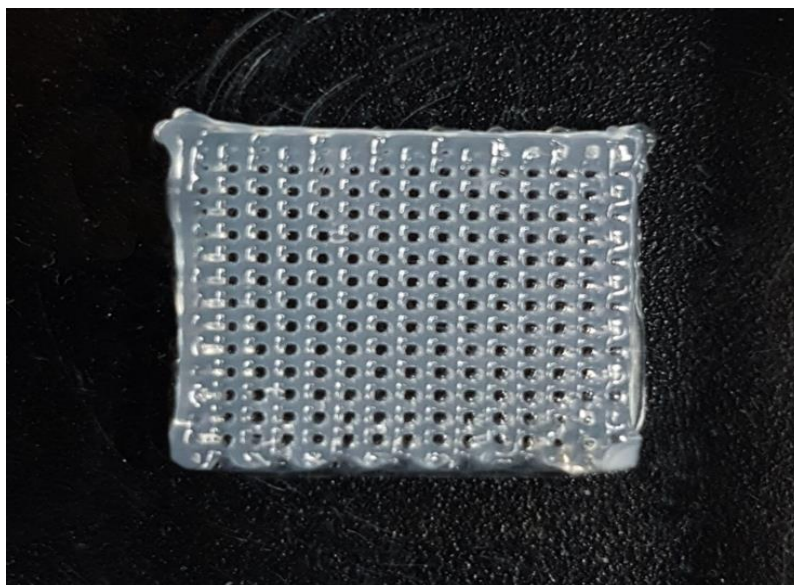
Рисунок 28 - Общий вид напечатанной 3D-структуры с использованием гидрогеля на основе коллагена I типа, содержащего клетки, х0,75
