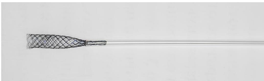
Рисунок 2.2 - Расправление стента при выведении из интродьюсера
