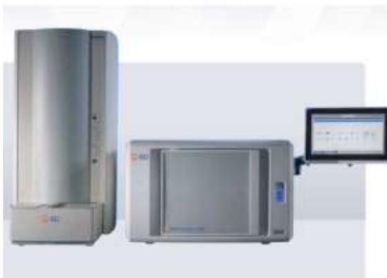
Рисунок 5 – Микробиологический анализатор «Phoenix M50» (BectonDickinson, США)
