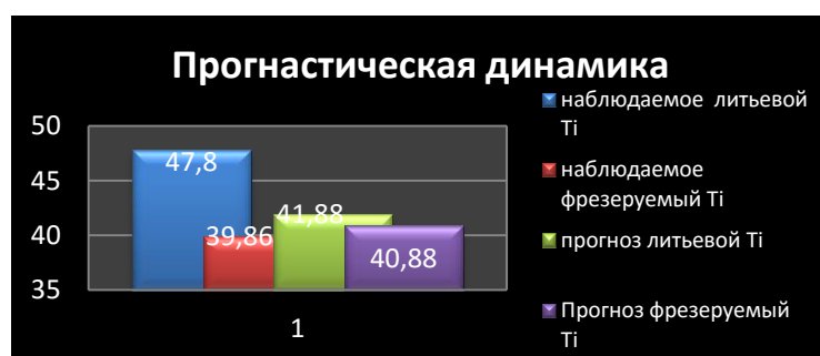
Рисунок 13 – Прогностическая динамика изменения разницы электрохимических потенциалов
